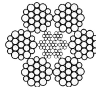
Канат двойной свивки с металлическим сердечником конструкции 6x19+(7x7). Широко применяется на строительных и металлургических кранах, а также на шахтных подъемных установках.
